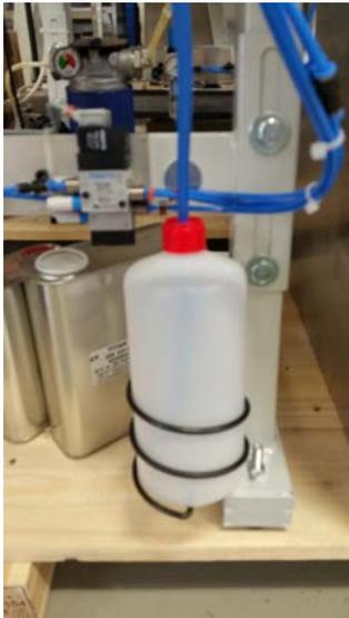
Occorre controllare la spia dell'olio ad intervalli regolari . Se il livello dell'olio **NON SI TROVA AL CENTRO DELLE 2 FRECCE ROSSE**, occorre aggiungere dell'olio nel serbatoio attraverso il tappo con la voce OIL, sopra la spia.Svitare tappo con arnese speciale (vedi pagina precedente).
